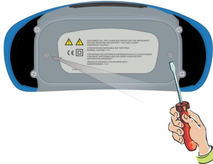
Figure 14.1: Position des vis pour ouvrir le compartiment de la batterie / des fusibles
