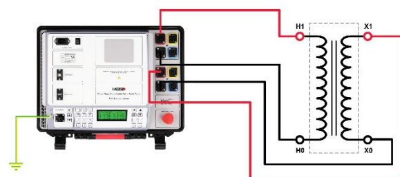
TRT 连接单相变压器
